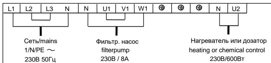
Для корректной работы электронной защиты мотора от перегрузки необходимо, чтобы ток тек через все 3 сетевые клеммы блока управления (для этого перемкнуть клеммы L2 и L3, а также U1 и V1), **насос подключить к клемме W1.**
