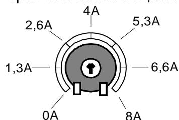
Фильтрующий насос защищен электроникой от повреждений, вызванных токовой перегрузкой. Для настройки защиты под конкретный насос необходимо согласовать величину тока срабатывания защиты с рабочим током фильтрующего насоса (смотри табличку на двигателе). Регулятор тока срабатывания находится внутри блока управления на монтажной плате. Если рабочий ток двигателя насоса не известен, то можно настроить защиту следующим образом:
