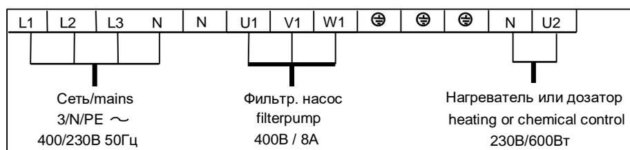
**Подключение насоса переменного напряжения 230В**
